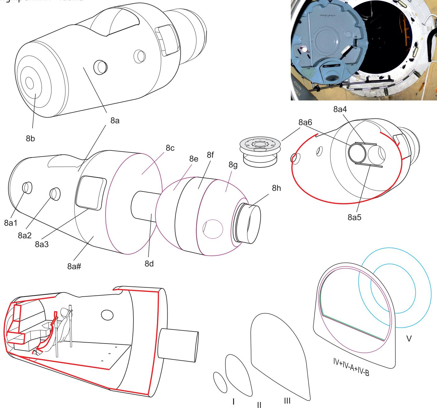
При сборке аппарата с интерьером – шпангоуты III и IV следует приклеивать к внутреннему отсеку, после чего устанавливать внутрь корпуса.
